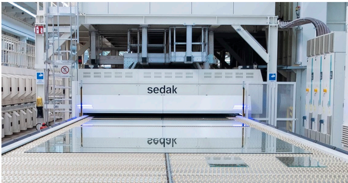
Dieser Scanner dokumentiert alle Gläser die auf unserem Ofen vorgespannt werden.
